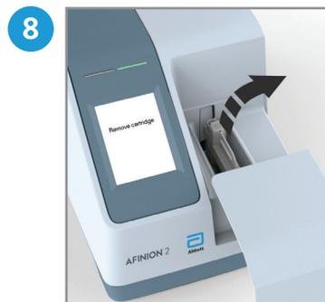
Retirer et jeter immédiatement la cassette de dosage utilisée. Fermer le couvercle manuellement lorsque l'analyseur n'est pas en cours d'utilisation.
