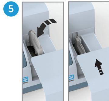
Insérer soigneusement la cassette de dosage avec le code-barres à gauche. Fermer le couvercle manuellement pour lancer l'analyse.
