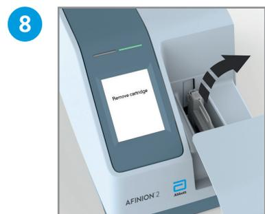
Die gebrauchte Testkassette entnehmen und unmittelbar entsorgen. Den Deckel manuell schließen, wenn das Analysegerät nicht in Gebrauch ist.
