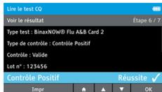
Les écouvillons permettent de contrôler l'ensemble du test. Procéder au test de ces écouvillons pour chaque nouveau lot reçu et pour chaque opérateur qui n'a pas encore été formé. D'autres contrôles peuvent être testés afin de se conformer :
