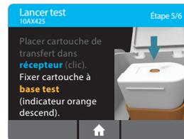
Lorsque la Cartouche de transfert est correctement fixée à la Base test, l'indicateur orange sur la Cartouche de transfert descend. Si l'indicateur orange ne descend pas, continuer à pousser sur la Base test jusqu'à ce que l'indicateur descende.
