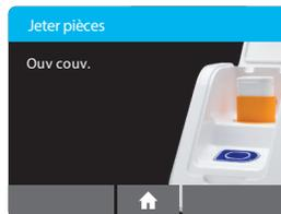
Retirer les pièces de test : pour ce faire, retirer la Cartouche de transfert de la Base test et la clipser dans le Récepteur d'échantillon, en appuyant fermement.
