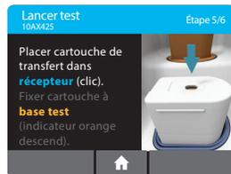
Lorsque la Cartouche de transfert est correctement fixée au Récepteur d'échantillon, l'indicateur orange sur la Cartouche de transfert monte. Si l'indicateur orange ne monte pas, continuer à pousser sur le Récepteur d'échantillon jusqu'à ce que l'indicateur monte.
