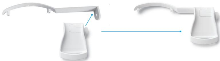
Raccorder le support à l'arrière du lecteur DIGIVAL. Brancher le lecteur de codes-barres sur le port USB et le placer dans l'étui.
